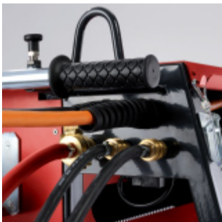
Priključak vode na pogonsku jedinicu
