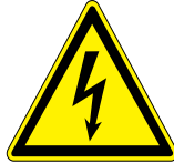
Осторожно: высокое напряжение
